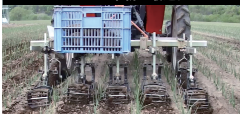
●新玉除草カルチ A 4畦 (レーキ無・玉ねぎクラッシャー付) 型式：H018-4BHA 玉ねぎの中耕に最適。
