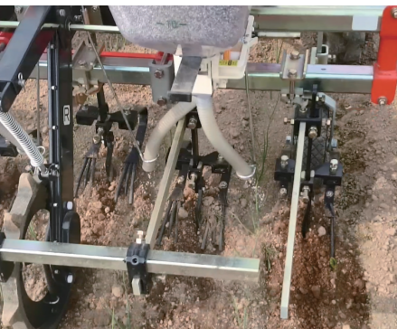
●施肥機4本タイプ (接地輪タイプ・ホッパー4) 型式：H020-4A 大容量タイプ
