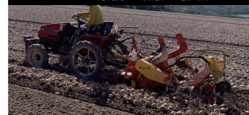
●デガー (ロッドタイプ・タイヤ手動) 型式：H040-1EHA 玉ねぎの集積、堀取に最適。
