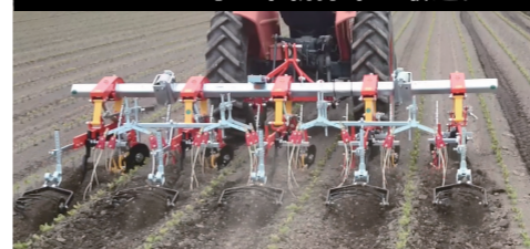
●ハイテクカルチ5畦 (碎土輪・碎土クラッシャー・ウルトラQ付) 型式：H003-5JHA ビート・豆等の中耕除草に最適。
