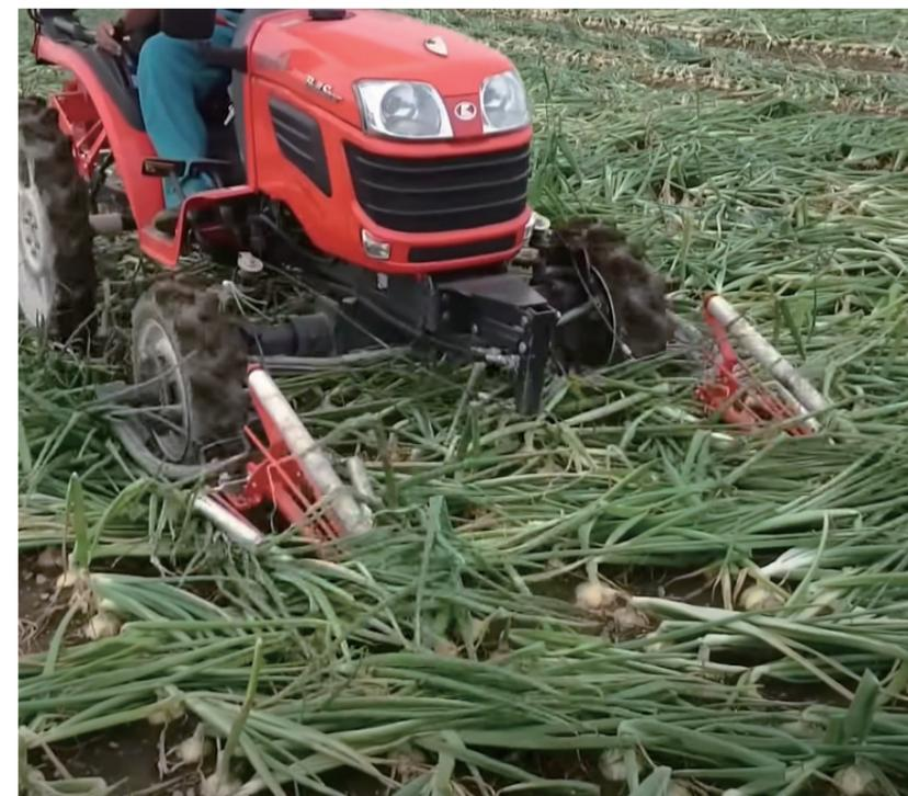
玉シャトルは北海道限定商品になります。極早生等の玉ねぎの葉が枯れていない場合に、ロングローラーがゆっくりと葉を分けていくことで、葉が絡みにくく作業ができます。ロングローラーとサイドローラーは、葉の抵抗により回転する事で、葉を傷つけにくい構造になっています。葉が枯れた場合の根切、デガー作業時は、ロングローラーが必要ないので、旋回時に、長い分、ぶつかる可能性があるため、取り外しが可能になり、従来の葉分けと同じ長さで作業が可能になります。葉を分けるためのロッドは、自在に調整が可能になっています。
