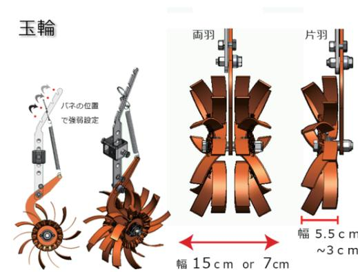
深耕カッターからでた土塊を砕く作業と、表層の土を砕いたり、攪拌したり出来ます。バネが内臓されているので、圃場の凸凹にも追従が可能で、土に刺さるテンションの強さも設定が可能です。
