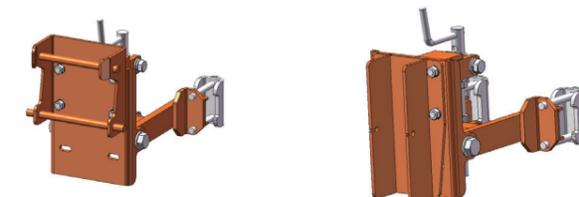
アイサイカ・HV 用 田植機用ヒッチ (溶接加工)
