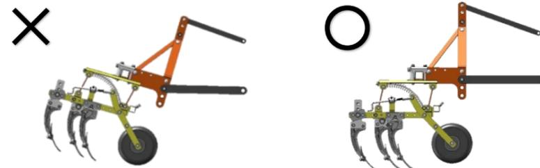
②カルチ幅の調整をします。作物の違いや圃場条件の違いで実際の条間と違う場合があります。その時はボルトを緩め実際の圃場の条間にカルチを調整して下さい。
