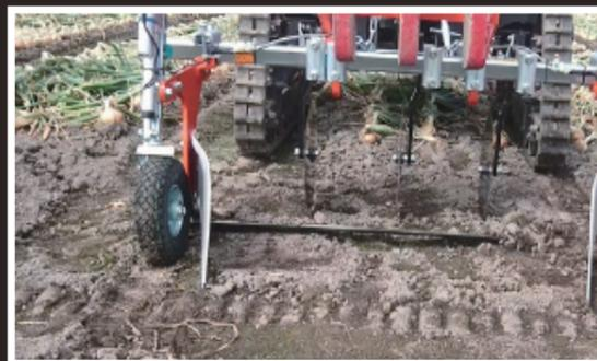
切断前の様子。玉ねぎの間にコールターが入るように根切機の位置をセットして作業を行います。
