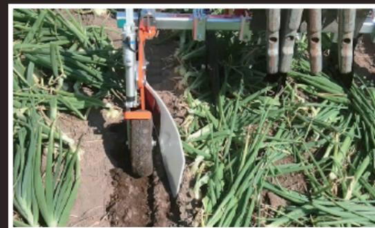
玉ねぎの葉をコールターで切断しています。運転操作を誤ると、玉ねぎも切断してしまう場合もあります。
