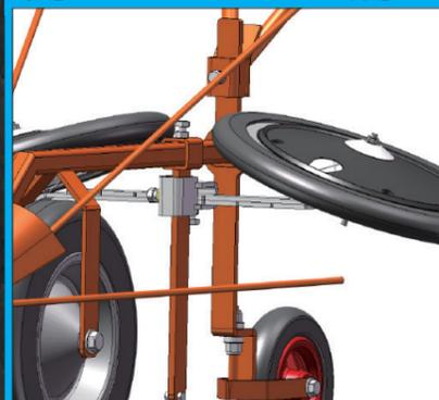
男女問わず作業が行えるように、ハンドルの高さはお好みに設定出来ます。トラクタもホイール・クローラにより異なる防除通路幅に対応するため、タイヤのスライドも自由に出るので、葉を倒す強弱も調整が可能になっています。
