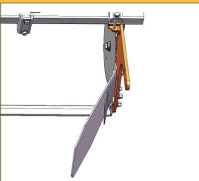
スリックは玉ねぎの大きさに応じて上下の角度を変える事が出来ます。玉ねぎの品種により、スリック内側の鉄板を外すことで、玉ねぎがスリックに当たる強さを変える事が出来ます。
