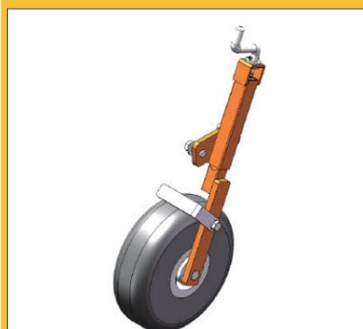
タイヤは根切により玉ねぎを踏まないために後方に設置しています。
