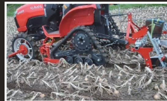
後輪デバイダは走行中も圃場の凸凹に追従出来るように自動高低装置を備えています。
