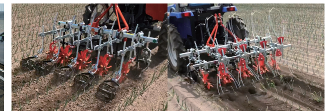
玉輪 15cm 使用での中耕写真 (北海道撮影) 条間 27 以上に最適な玉輪
