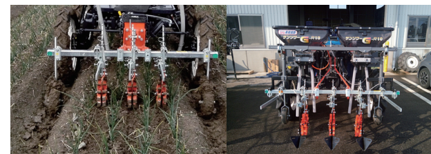
玉輪 7cm仕様の中耕と、取り付け状態 (都府県撮影) 条間 20 ~ 27cm 未満に最適な玉輪
