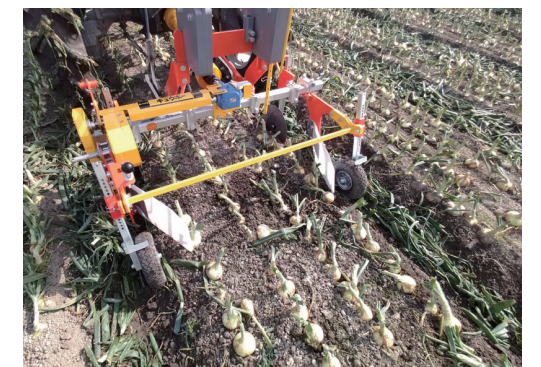
回転棒による玉ねぎ根切作業の様子
