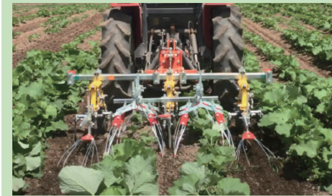
取付機種：トラクタ うね体型：べたうね 取付作業機：S4カルチ 3条 ウルトラQ 1条×2 日農工標準オートヒッチ
