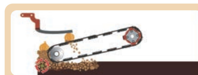
②玉ねぎが土塊とともにコンベアへと力強く押し上げ玉ねぎの跳ね上りをゴムシートが押さえて整えます
